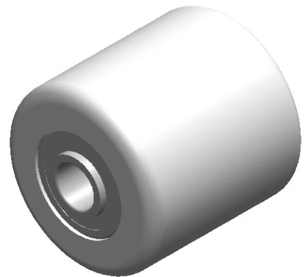
2x Rillenkugellager DIN625-6204-ZZV
